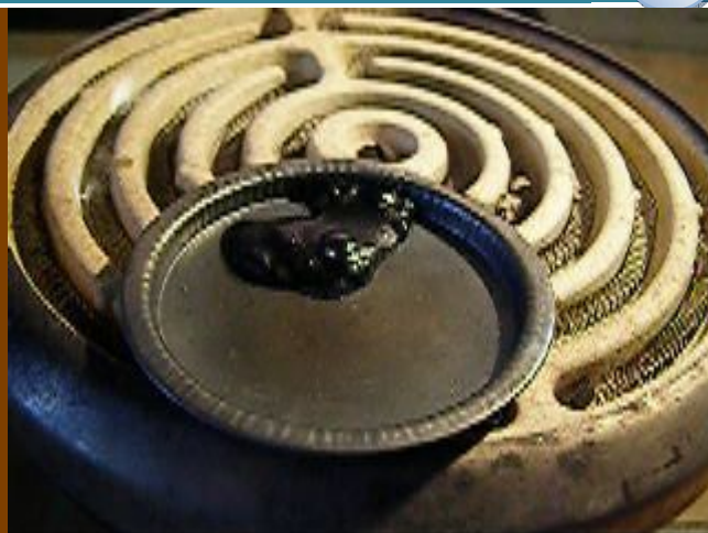
Разложение \text{KCr}(\text{SO}_4)_2 \cdot 12\text{H}_2\text{O} фото В.Н. Витер
