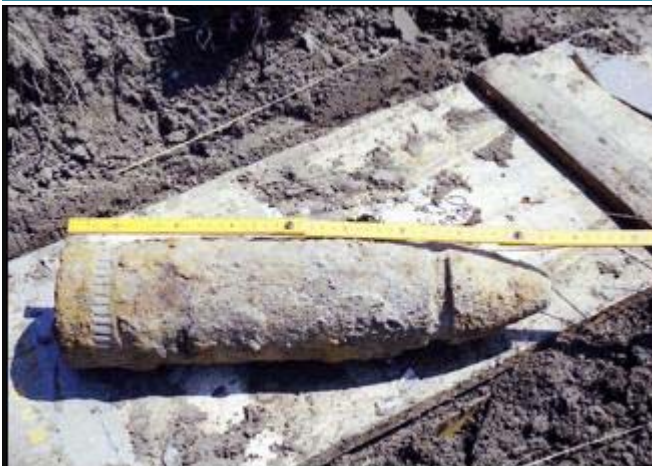
Итальянский снаряд калибром 105 мм., оснащенный фосгеном
