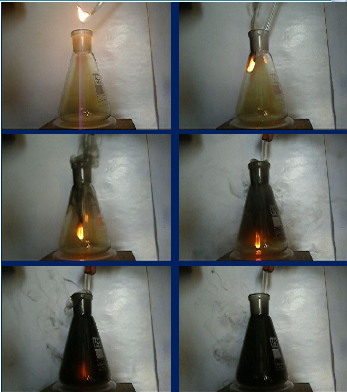
Горение пропан-бутановой смеси в колбе с хлором. фото В.Н. Витер
