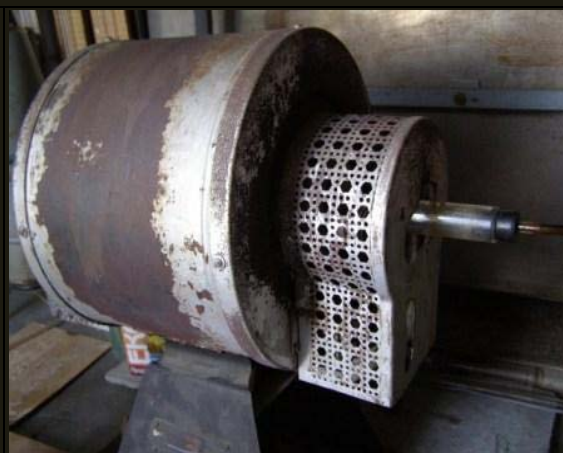
Муфель для нагревания в инертной атмосфере
