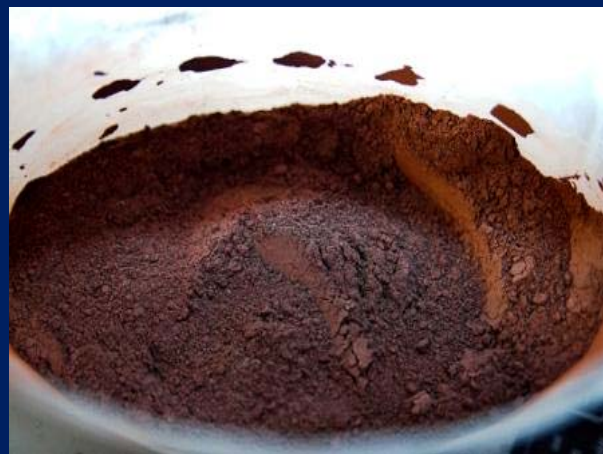
Термитная смесь \text{Fe}_2\text{O}_3 + \text{Al} (Wikipedia)
