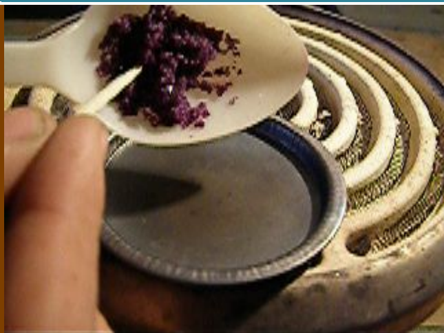
Разложение \text{KCr}(\text{SO}_4)_2 \cdot 12\text{H}_2\text{O} фото В.Н. Витер
