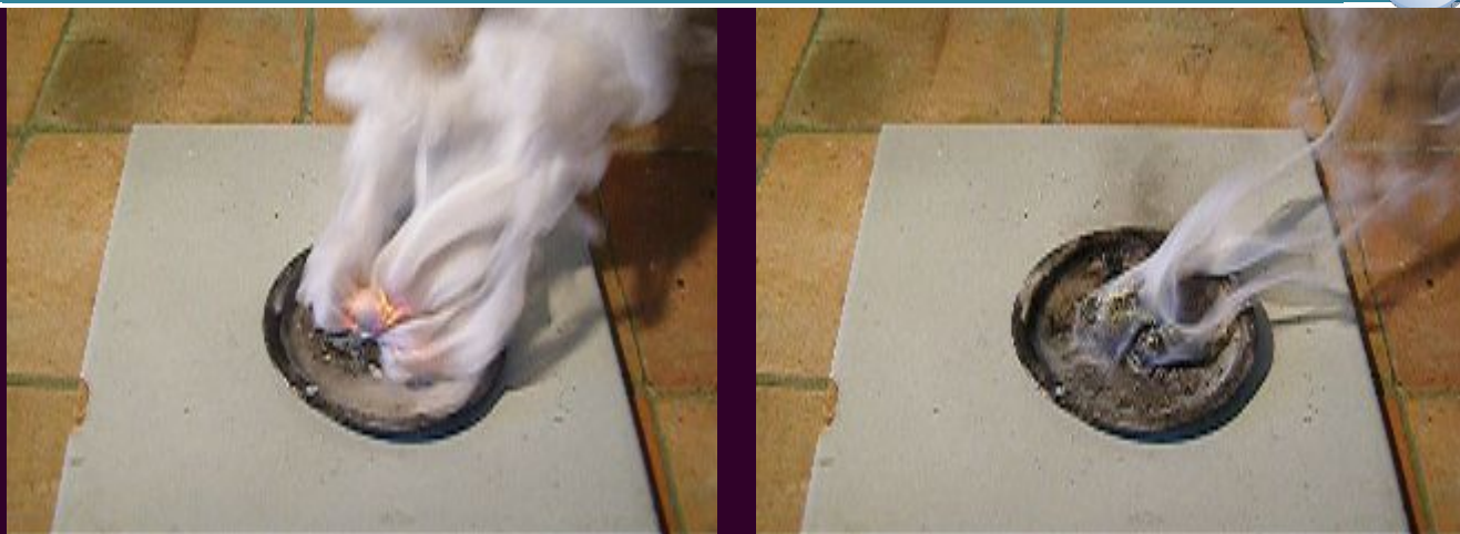
Горение смеси \text{CCl}_4 и цинковой пыли фото В.Н. Витер
