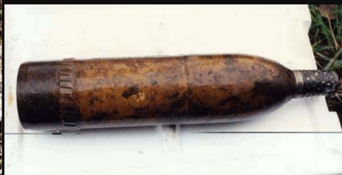
Французский 75 мм. снаряд, оснащенный хлорсульфоновой кислотой
